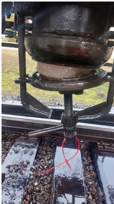
Фото 1 – Ледяная пробка в нижнем сливном приборе вагона № 73125379.
